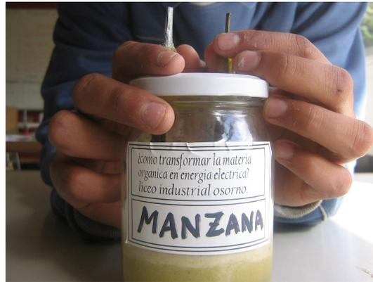
Al pasar la materia orgánica a un recipiente y aplicando placas bimetálicas de cobre y zinc, se puede formar en una pila o batería con la misma o mayor cantidad potencial energética que una pila convencional, lo que diferencia es porque no contamina y el costo es totalmente reducido a lo que sale fabricar las pilas actualmente, y esto no contamina. Entonces nosotros podemos extraer la electricidad con placas de cobre y zinc, del líquido y del sólido.
